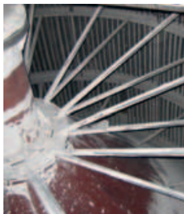
Ротор LSKS со сменными жалюзьями
