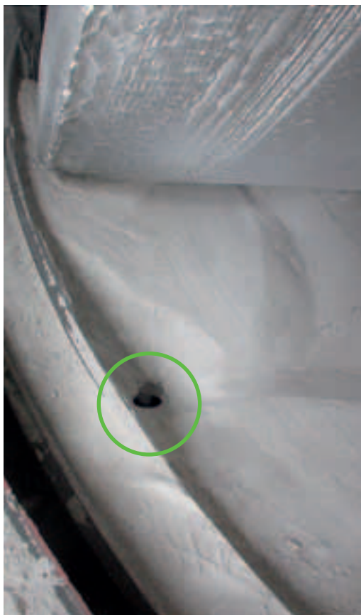
Технологические отверстия для вывода чужеродных частиц
